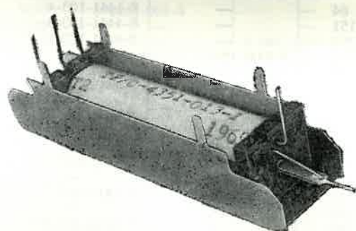
Rys. 18.7.2.1. Widok ogólny przekaźnika rurkowego typu PJ-1 (odmiany zob. w tabl. 18.7.2.1)
