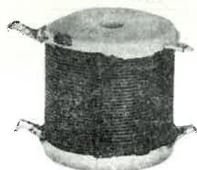
Rys. 10.2.1. Cewka oporowa 8 W
