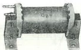
Rys. 12.1.1.1. Dławik stosowany w telefonicznych łącznicach ręcznych
