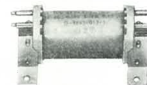
Rys. 12.2.5.1. Transformator telefoniczny stosowany w telefonicznych łącznicach ręcznych
