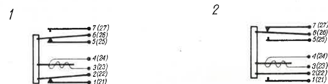
Rys. 18.6.19. Schematowe oznaczenie końcówek lutowniczych przekaźników cieplnych 1 — przekaźnik cieplny z zestykami 2+21, 2 — przekaźnik cieplny z zestykami 1+21
